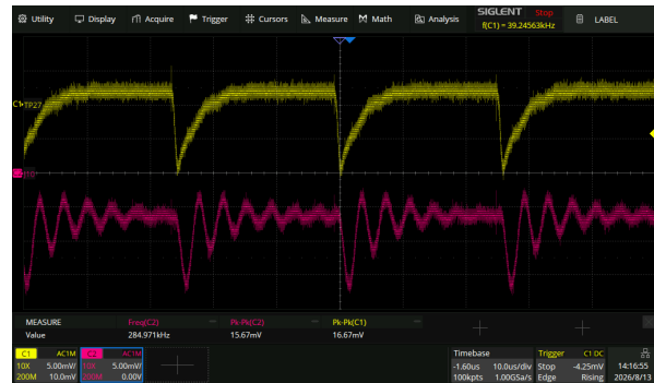
Figuur 2: 12 V vóór (J10, roze) en na (TP27, geel) de ingangsbescherming: 15,7 respectievelijk 16,7 mV pp . Het filter onderdrukt scherpe hoogfrequente ruis en dempt binnen enkele cycles uit.
