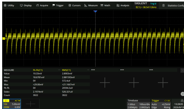
Figuur 1: 12 V rail (TP27), onbelast, 5 mV/div. Pieken van 19 – 25 mV pp tegen een criterium van 100 mV.
