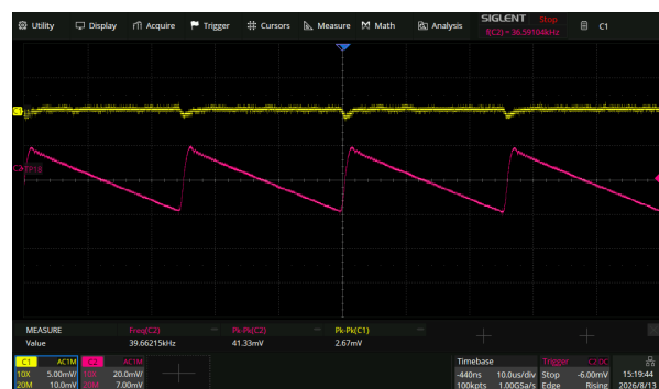
Figuur 4: 3,3 V digitaal (geel, 2,67 mV pp ) ten opzichte van de 3,8 V rail (roze, 41,3 mV pp ): circa 24 dB onderdrukking door de LDO.
