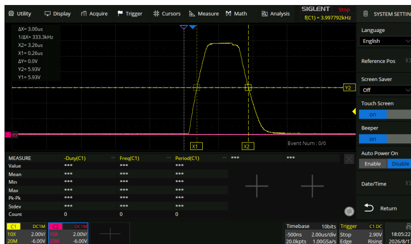
Figuur 8: Minimale puls met 330\ \Omega belasting: de staart verdwijnt grotendeels, breedte 3,00\ \mu\text{s} op het 5,93\ \text{V} -niveau.
