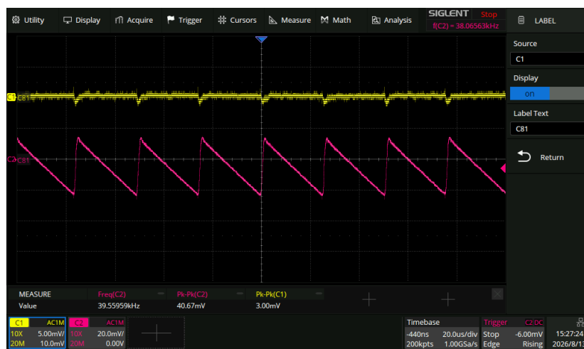
Figuur 5: 3,3 V analoge rail bij C81 (geel, 3,00 mV pp ) ten opzichte van de 3,8 V rail (roze, 40,7 mV pp ). Deze rail voedt de PT1000-meetketen.
