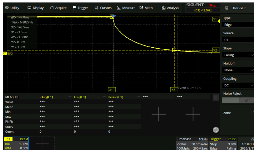
Figuur 9: Uitschakelen van de modemrail (TP2), 1 V/div en 50 ms/div: van 3,80 V naar 0,30 V in 147 ms, ruim binnen de 400 ms.
