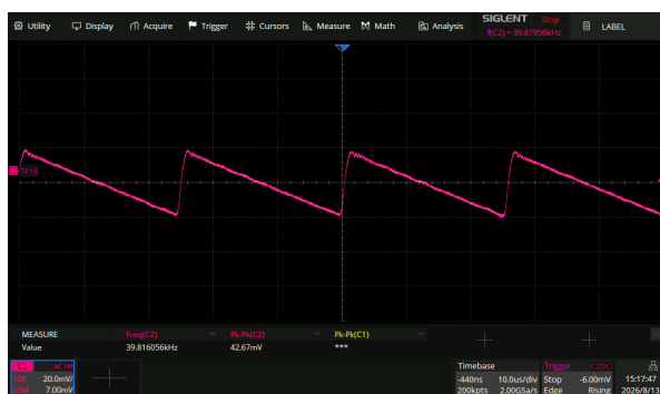
Figuur 3: 3,8 V rail (TP18), 20 mV/div: zaagtandvormige PSM-bursts van 42,7 mV pp bij 39,8 kHz herhaalfrequentie.
