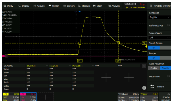
Figuur 6: Gemeten minimale puls op J4 pin 3 (4 kHz, 1 %, onbelast), 2 V/div en 2\ \mu\text{s}/\text{div} . Cursors op \approx 3,9\ \text{V} geven 5,40\ \mu\text{s} .
